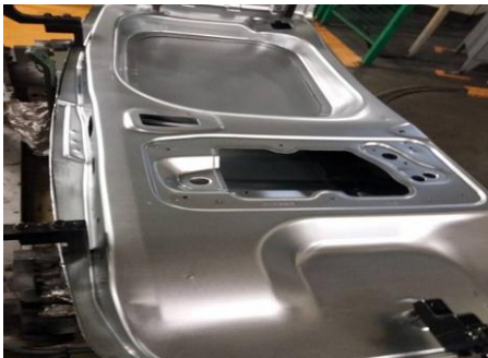
Figure 33 : Mariage panneau et caisson
