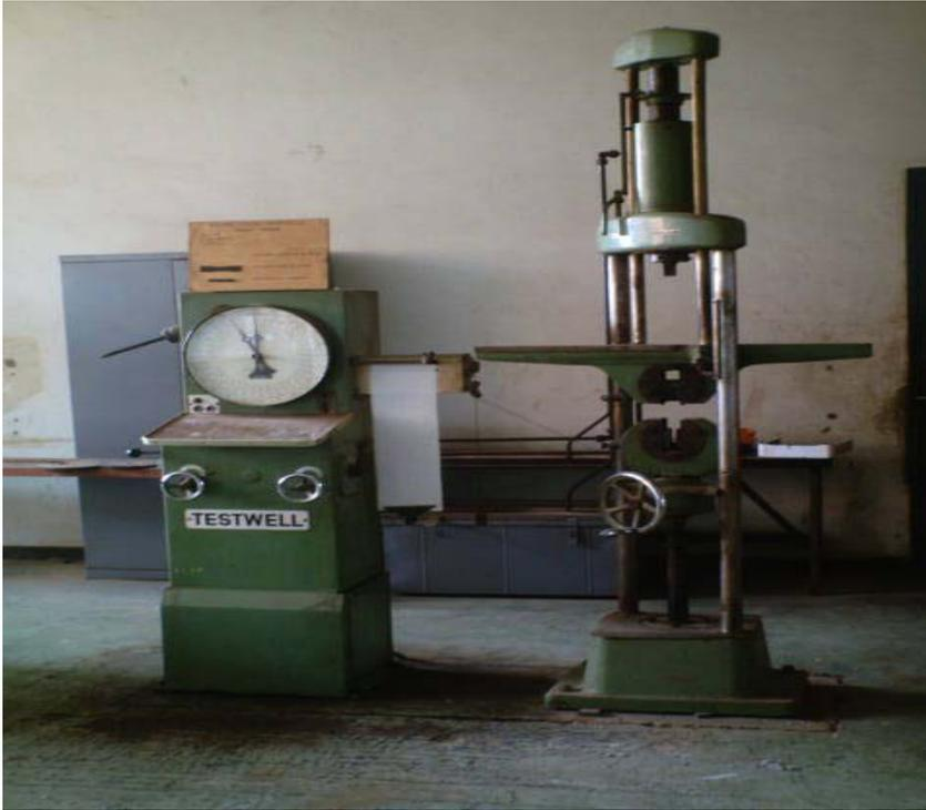
**Figure 25** :Machine multifonctionnelle du type TESTWELL
