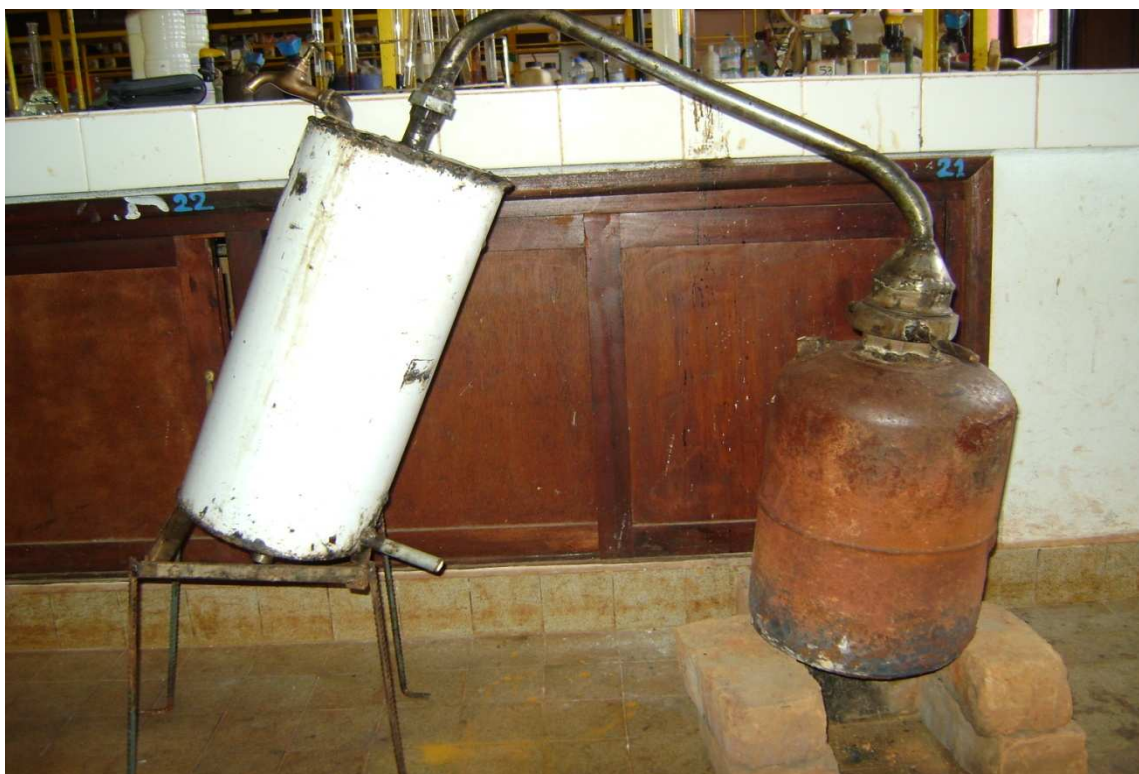
Figure 13 : schéma de l'appareil de pyrolyse.
