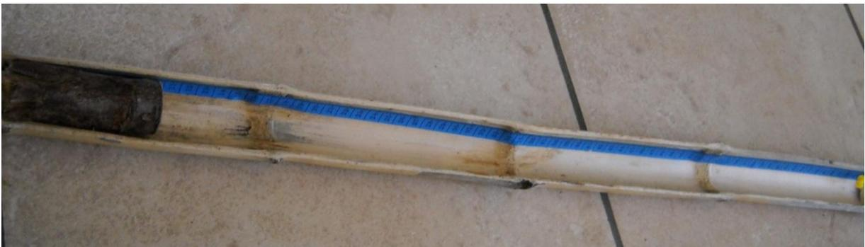
**Figure N°6 : Ichtyomètre en gouttière**
