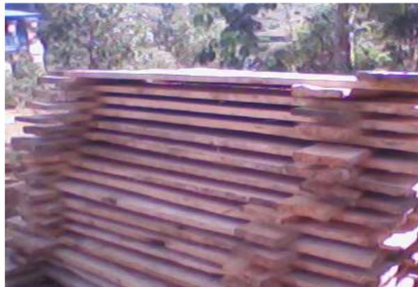
*Figure 17 : mode de séchage à disposition espacée*
