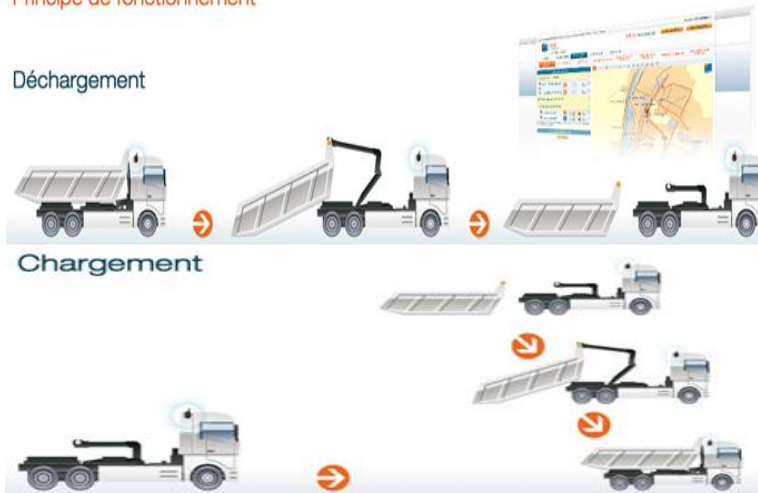
Figure 2.4.2 Principe de fonctionnement de la collecte les ordures ménagères avec un camion multi-benne
