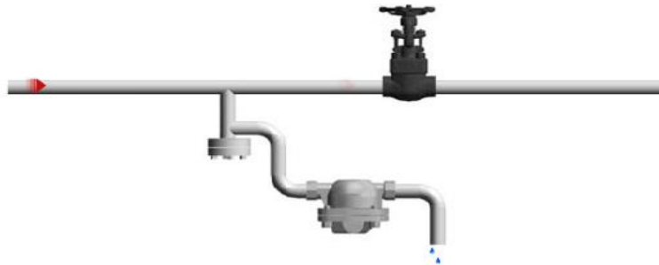
Figure 83: L'emplacement des purgeurs dans le cas 3
