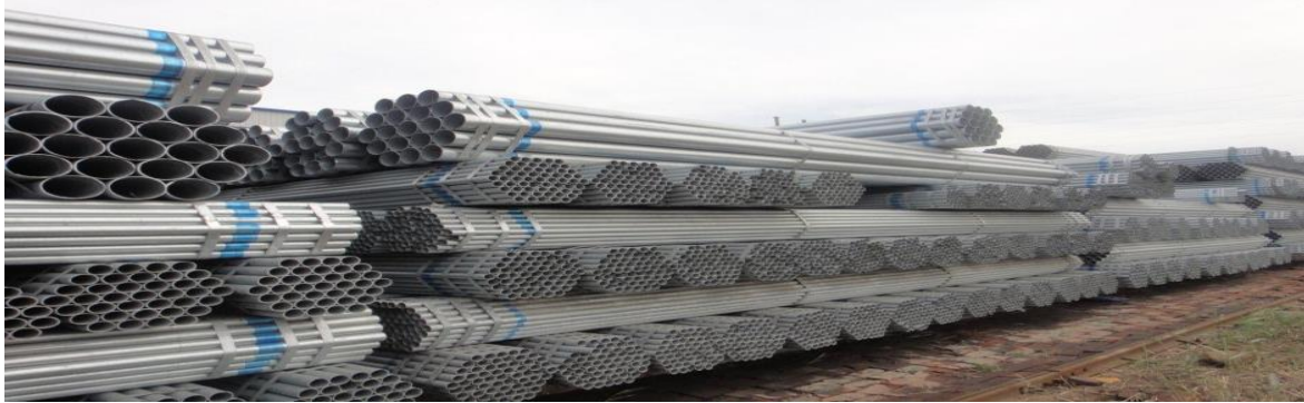
Figure 62: Conduites en S235JR
