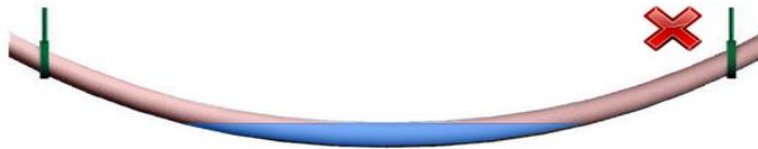
Figure 85: Accumulation de condensat a l'intérieur de la conduite
