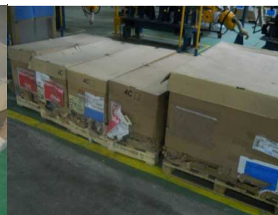
Figure 34 : Etat dégradé des palettes
