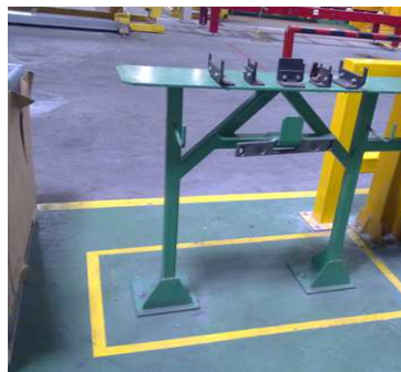
Figure 27 b : pièce posée sur jig
