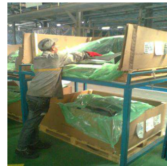
Figure 28: Support de stockage de palettes inadéquat
