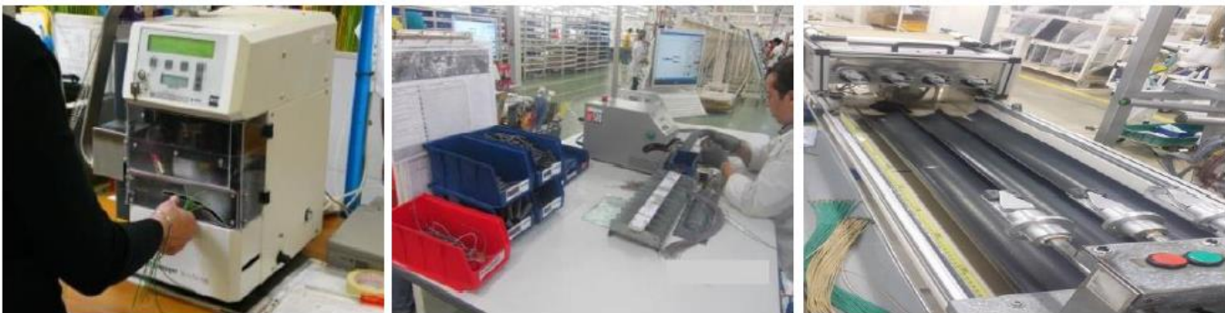
Figure 8 : Machines de Sertissage manuel, de Shunk et de Twist successivement.
