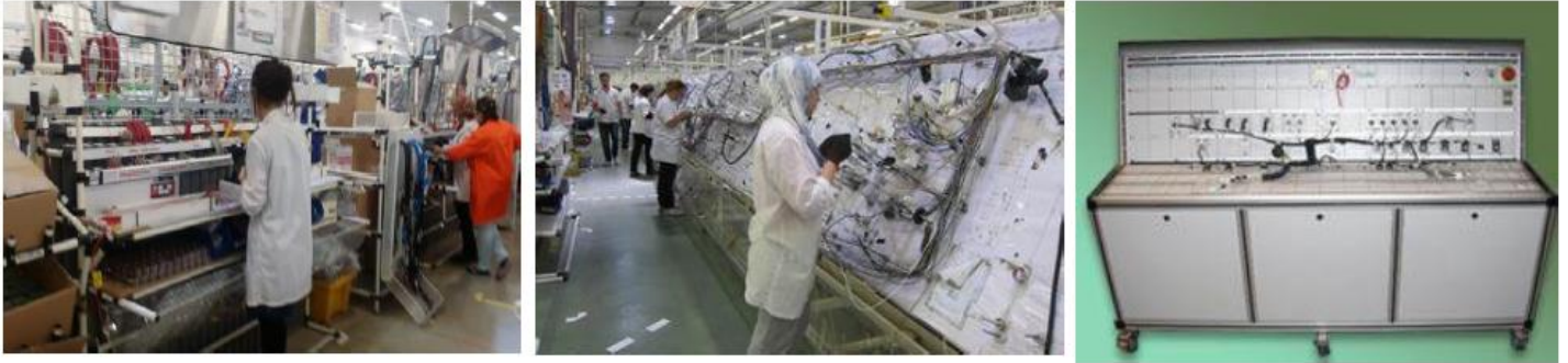
Figure 9 : Postes d'insertion, d'enrubannage et du test électrique successivement
