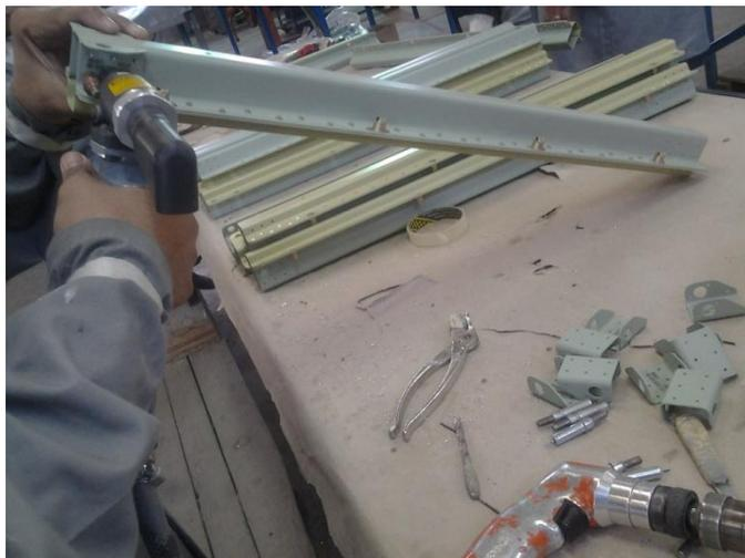
Figure 23: Rivetage des pièces dans le poste montage
