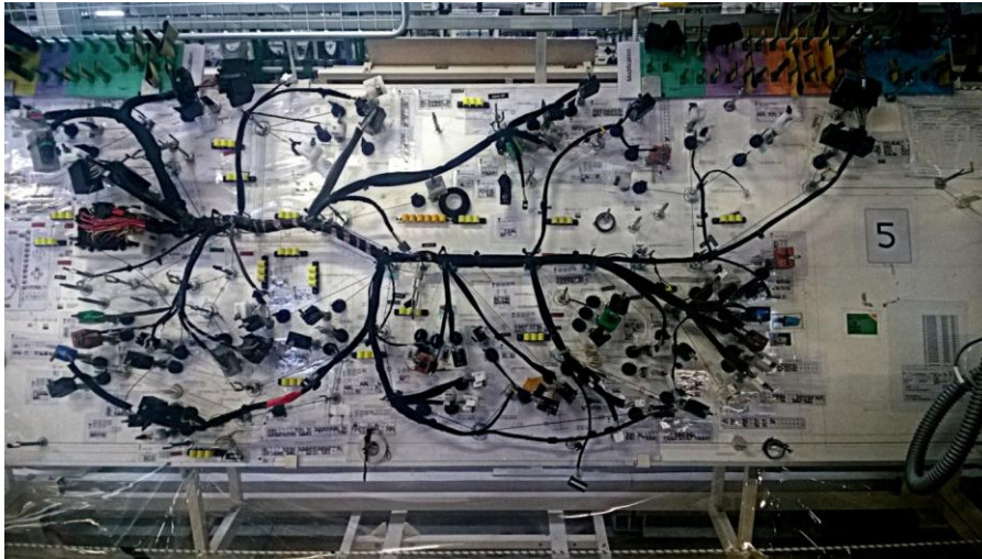
Figure 11: JIG de la zone d'assemblage
