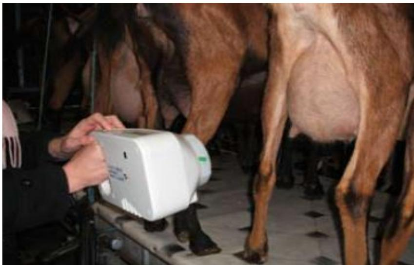
**Figure 25 : Prélèvements d'air à l'aide d'un biocollecteur**
