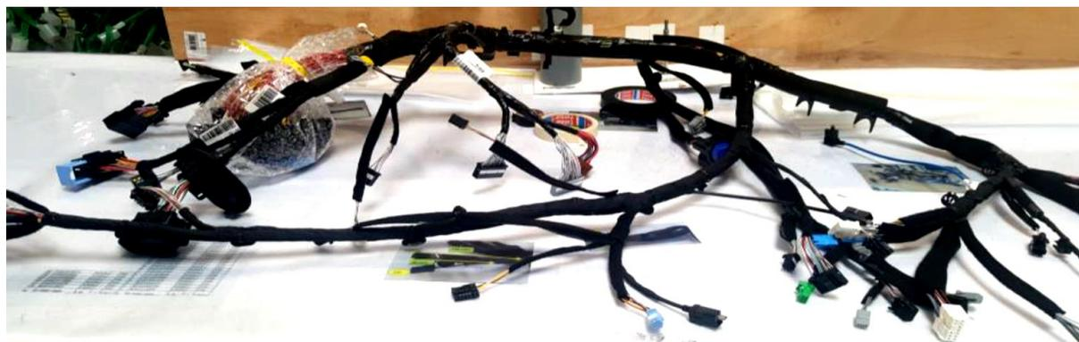
**Figure 5** : Exemple d'un faisceau électrique
