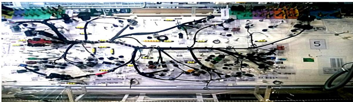
**Figure 12** : JIG de la zone d'assemblage
