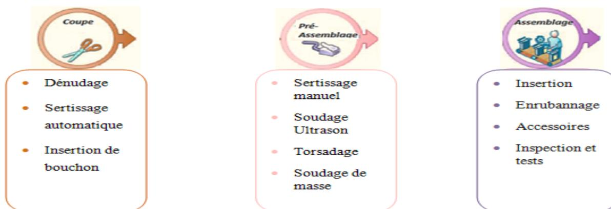
**Figure 11** : Flux de production d'un faisceau électrique
