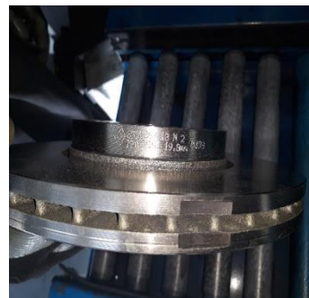
Figure 12 : Contrôle DIM et marquage des disques
