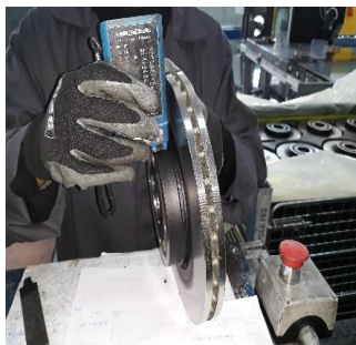
Figure 15 : Contrôle d'aspect et mise en caisse des disques
