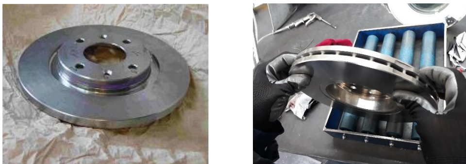
Figure 8: Les disques de frein pleins et ventilés
