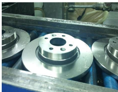
Figure 10 : Opération de perçage
