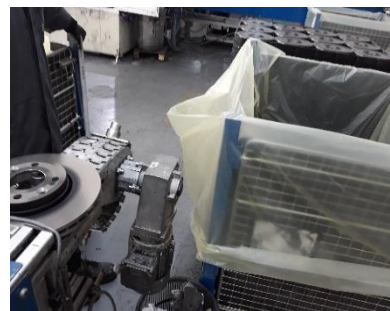
Figure 15 : Contrôle d'aspect et mise en caisse des disques
