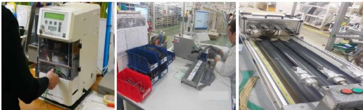
Figure 10: Machines de Sertissage manuel, de Shunk et de Twist successivement
