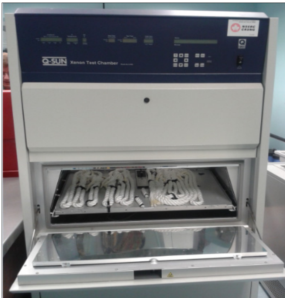
Figure 2.4 : Chambre climatique pour exécuter le vieillissement
