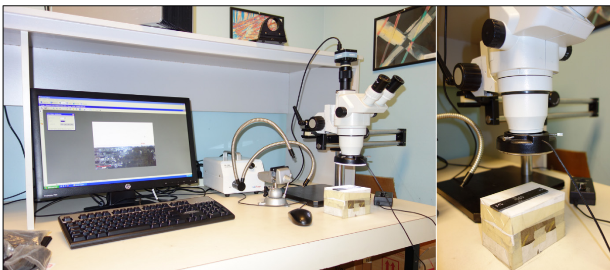
Figure 2.28 Montage pour les mesures de délaminage
