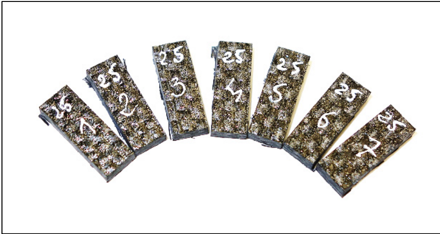
Figure 2.15 Éprouvettes d'essai short beam
