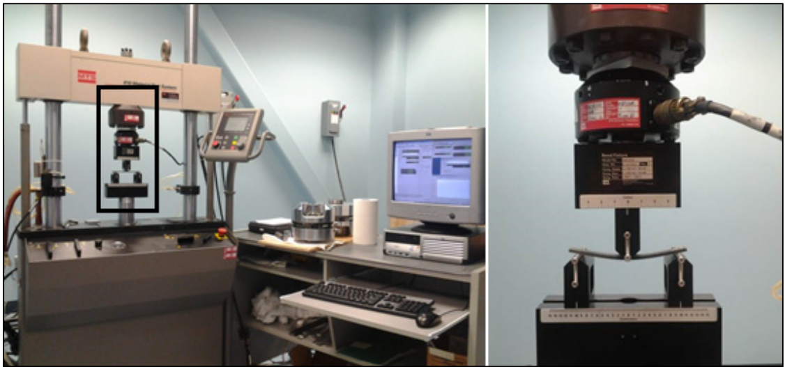
Figure 2.12 Montage de flexion trois points
