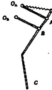
Figure 20 Mécanisme à quatre barres rigides (four-bar linkage) de Chebychev avec ressort de traction (Adapté par V.K Papantoniou)
