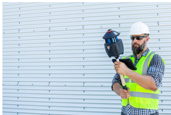
Fig. 23 - Scanner laser 3D à technologie SLAM PX 80
