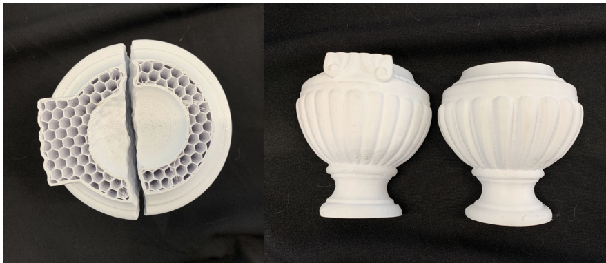
Fig. 26 - Impression 3D après scan 3D d'un élément en pierre
