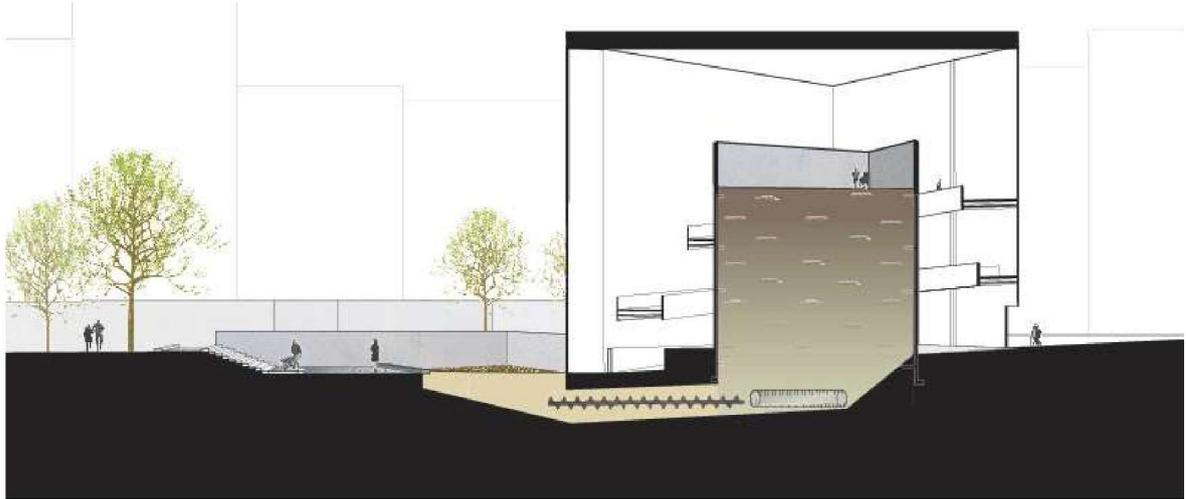
Figure 18 : Coupe dans le bâtiment, silo de décomposition et son mécanisme, rampes en spirale, placette extérieure, rendu extrait du mémoire de Katrina Spade « Of Dirt and Decomposition : Proposing a Place for the Urban Dead » <sup>78</sup>
