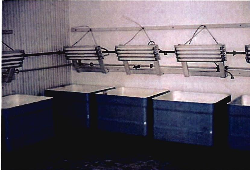
Figure 1.4 : Réservoir rectangulaire avec éclairage supérieur pour la culture en masse de microalgues
