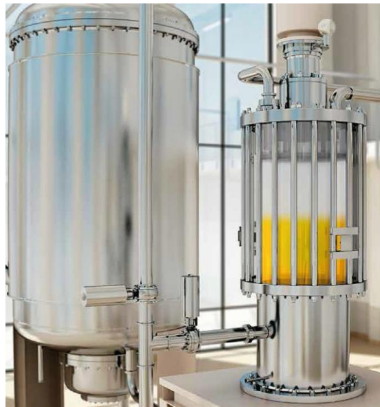
Figure 15 Installation à grande échelle d'un système de cryoconcentration par suspension
