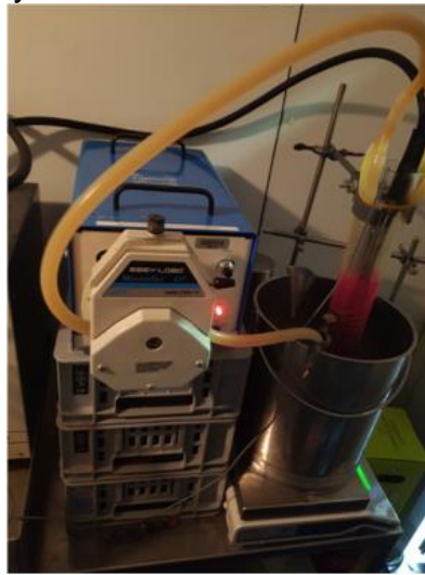
Figure 6 Présentation du système de cryoconcentration par bloc partiel utilisé lors des essais
