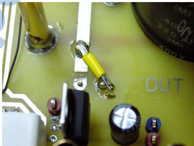
Figure 5 : Modifications sur le PCB
