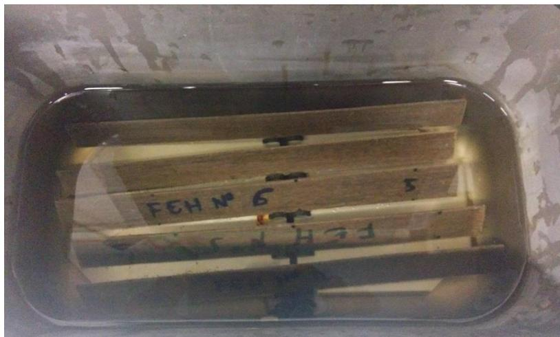
Figure V.2. Échantillon FEH immergée dans de l'eau distillée
