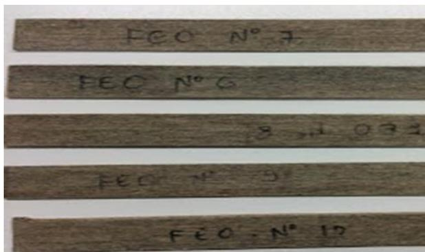
Figure III.4. Échantillons de dimensions normalisées selon ASTM D3039
