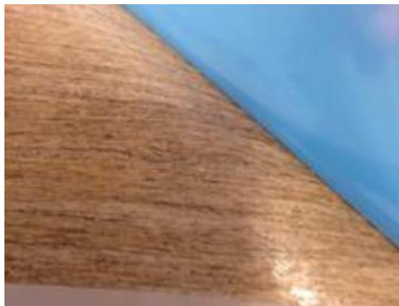
Figure III.2. Préimprégné de lin/époxy unidirectionnel Flaxtape 110
