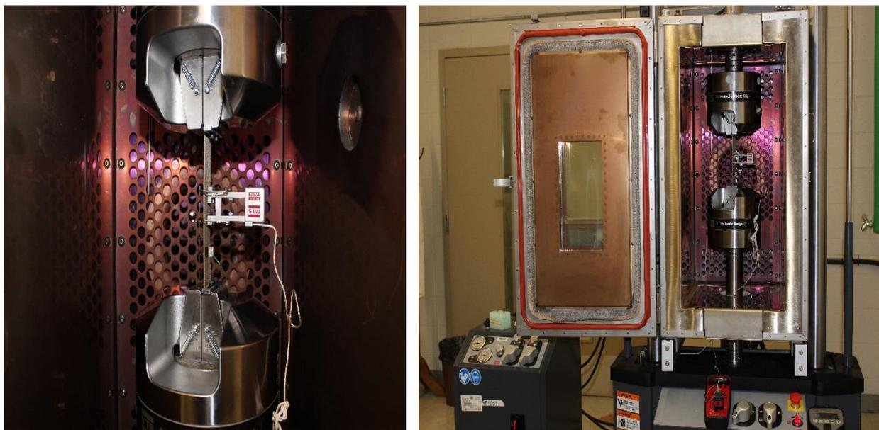
Figure V.4. Dispositif d'essai de traction avec la machine MTS 809 dans une chambre environnementale couplée avec un extensomètre et un thermocouple
