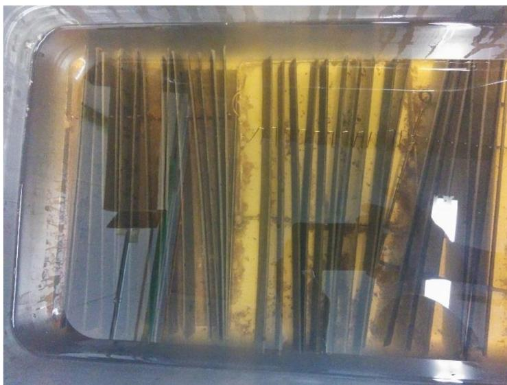
Figure V.8. Échantillons FEH vieillis dans le bain thermal
