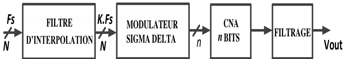
Figure 3.7 : Architecture d'un CNA Sigma-delta
