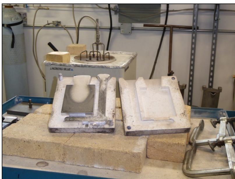
Figure 2.6 Plaque obtenue après coulée
