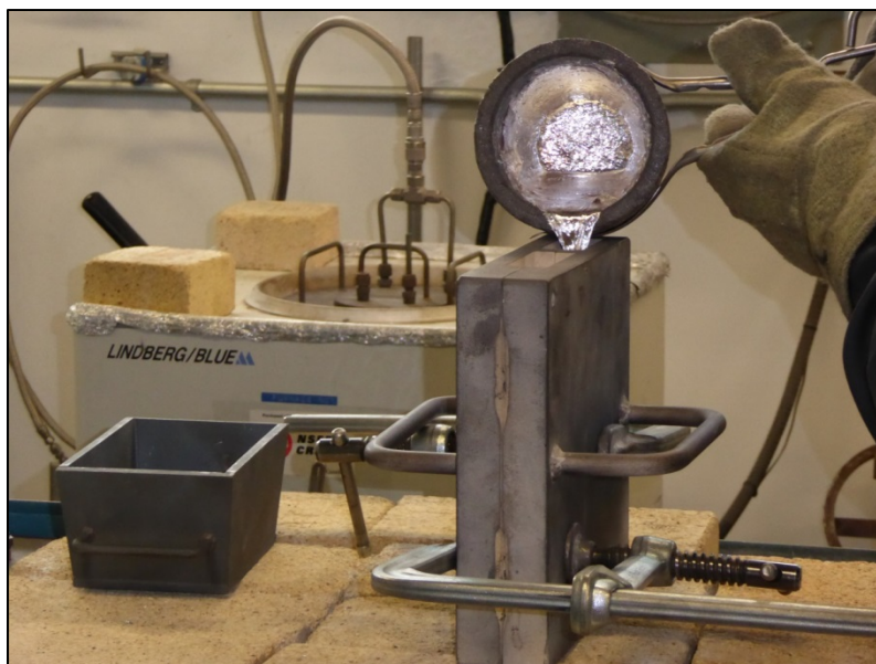
Figure 2.5 Coulée de l'alliage
