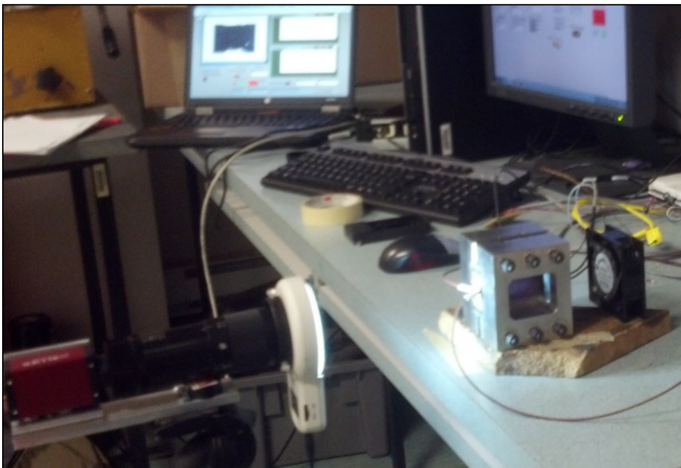
Figure 2.19 Suivi de la déformation par caméra
