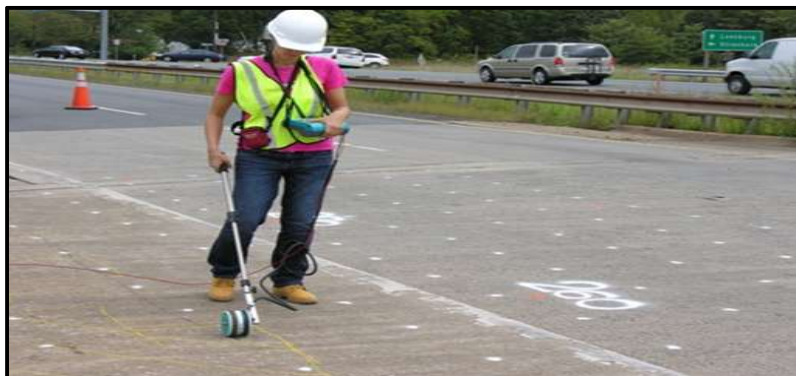
Figure II.2 : Mesure du potentiel à l'aide d'une roue à électrode [27].
