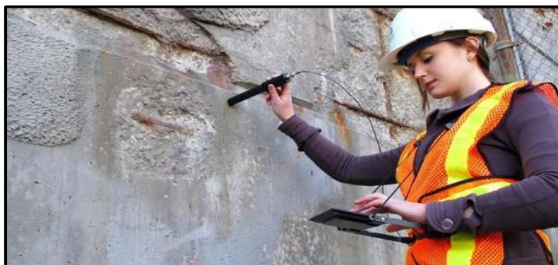
Figure II.3 : Mesure du potentiel à l'aide de barre électrode [28].
