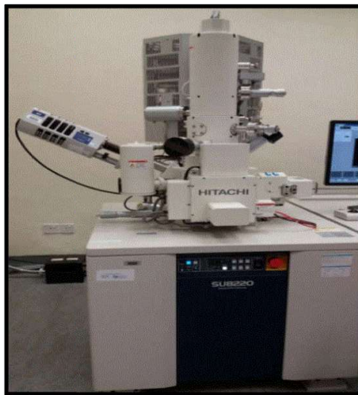
Figure III.2 : Microscopie électronique à balayage MEB/ EDX (HitachiSU8220 Ultimate Cold Field) [62].
