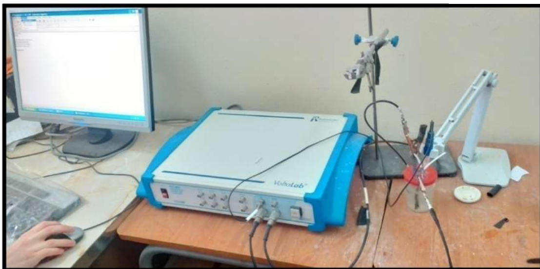
Figure II.23: Schéma représentatif de la chaîne électrochimique de mesure utilisé au laboratoire EOLE.
