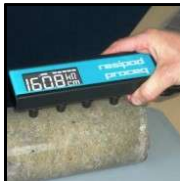
Figure II.8: Exemple de matériel commercialisé pour la cartographie de la résistivité de type Wenner (IFSTTAR) [35].
