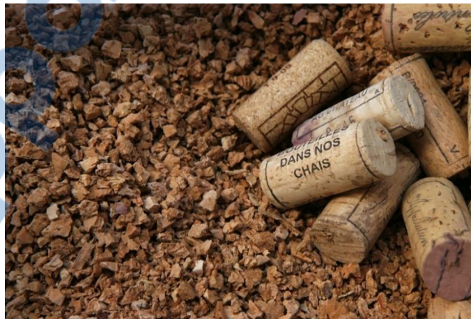
Figure I-8: Granulats de liège (tiré de : biosfaire-materiaux.com)
