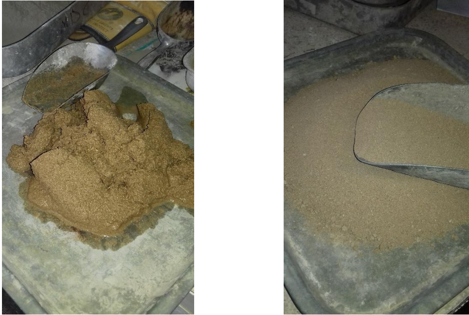
Figure III-5: Essai de l'absorption du sable (photo prise au laboratoire)
