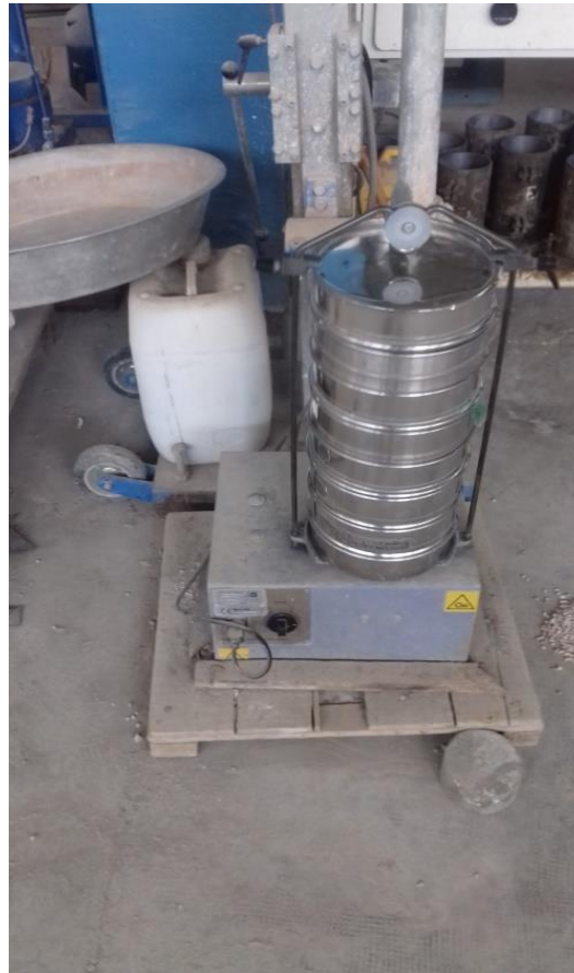
Figure III-6: Analyse granulométrique (photo prise au laboratoire)
