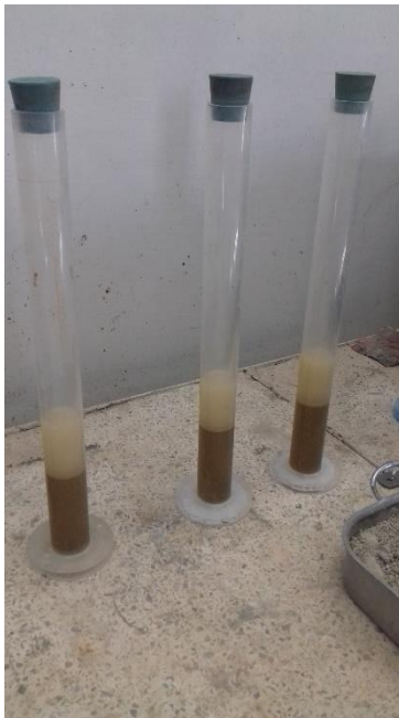
Figure III-4: Essai de l'équivalent de sable (photo prise au laboratoire)
