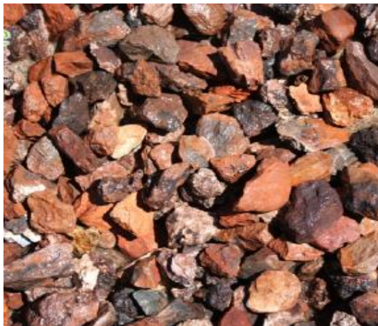
Figure I-6: Schiste expansé (tiré de : ecobiotex.fr)
