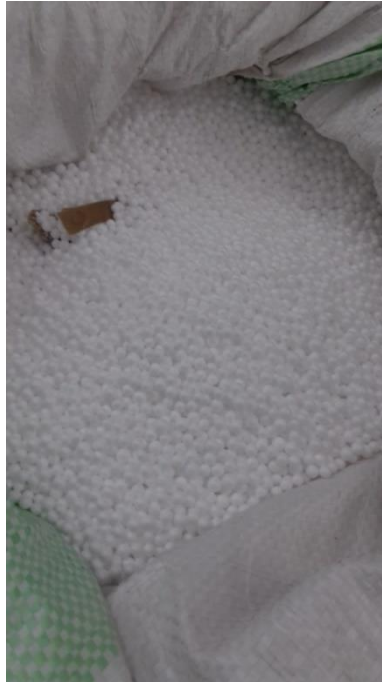
Figure III-8: Billes de polystyrène expansé (photo prise au laboratoire)
