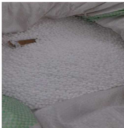
Figure I-9: Polystyrène expansé (photo prise au laboratoire)
