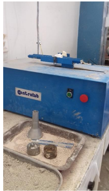
Figure III-4: Essai de l'équivalent de sable (photo prise au laboratoire)
