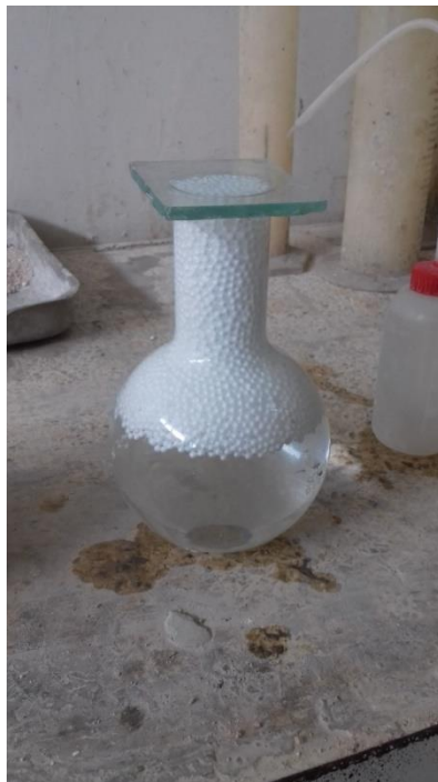
Figure III-9: Masse volumique méthode du ballon (photo prise au laboratoire)
