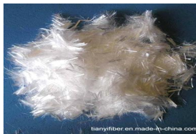
Figure 3.22. Fibres de polypropylène
