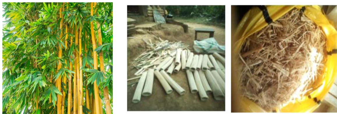
Figure 3.14. Fibres végétales de Bambou épluché et défibré (Abessolo et al.2020)
