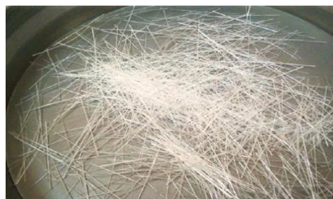
Fibre de verre (type Cemfil AR)
