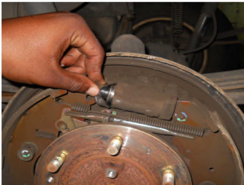
Figure 4.16 : Joint cache poussière de cylindre de roue [20]
