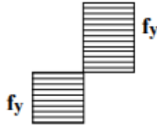
Figure 7 : Diagramme des contraintes de flexion dans une section de classe 1,2.
