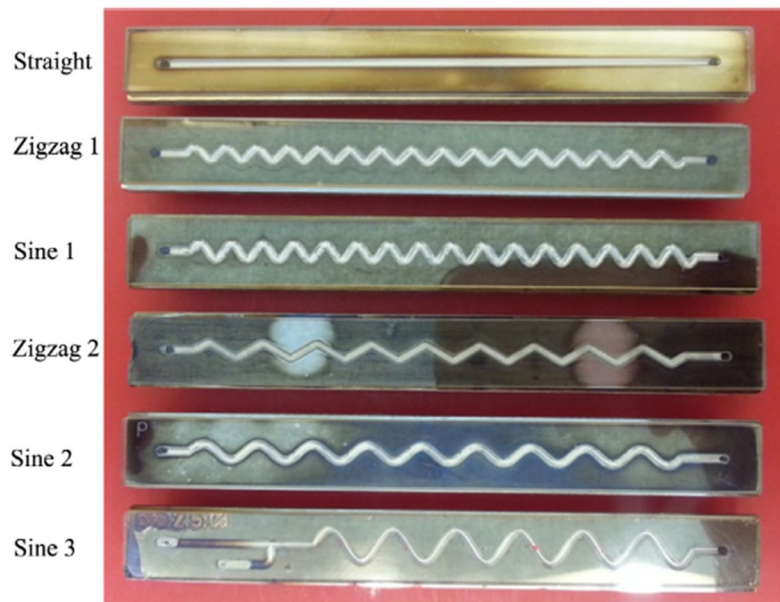
Figure I.9 : Photographie de sections d'essai avec différents modèles de canaux [35].
