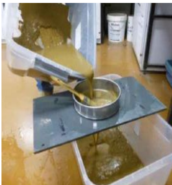
a. Essai de tamisage par voie humide
