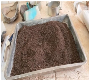
Photo III.12 : Étapes de réalisation de l'essai Proctor Normal sur le sédiment de Beni Bahdel.
