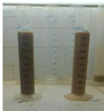
b. Essai de sédimentométrie
