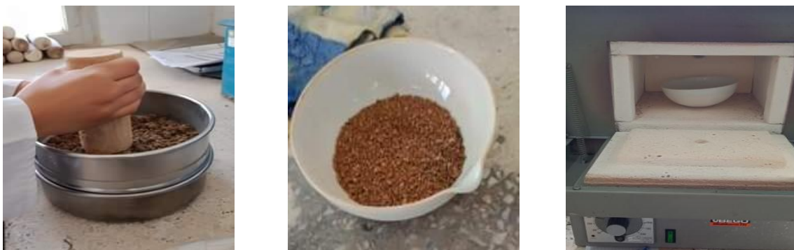
Photo III.6: Détermination de la teneur en matières organiques (MO) du sédiment de Beni Bahdel par la méthode de calcination
