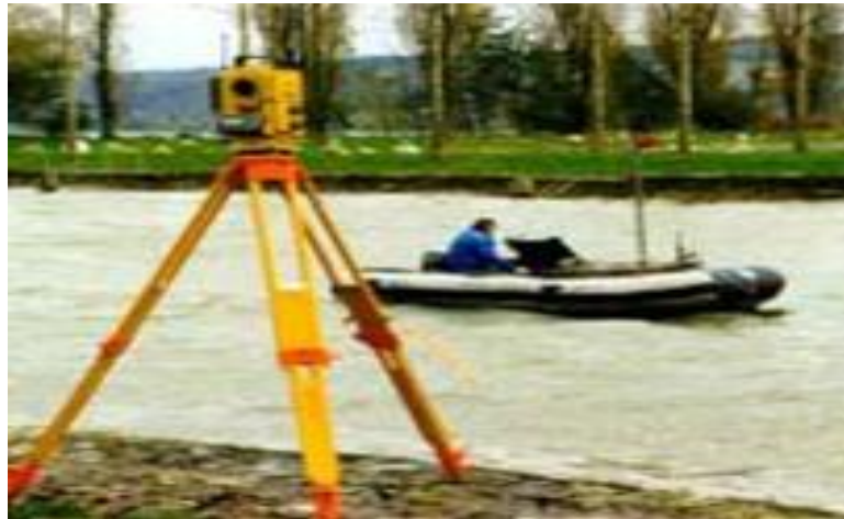
Photo I.1 : Estimation de l'envasement par la méthode de nivellement (Tachéomètre) (Benahmed, 2015)
