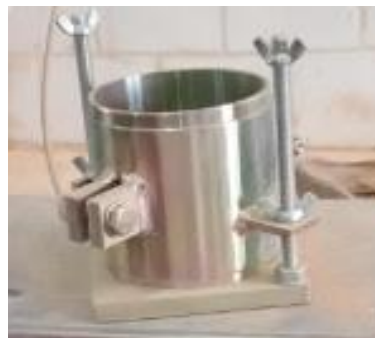
Photo III.12 : Étapes de réalisation de l'essai Proctor Normal sur le sédiment de Beni Bahdel.
