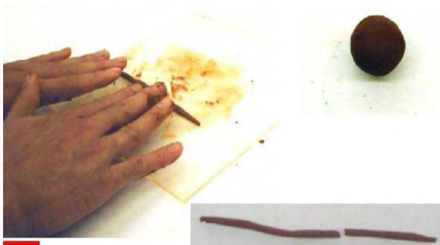
Photo III.9 : Les étapes d'exécution de l'essai de la limite de plasticité.
