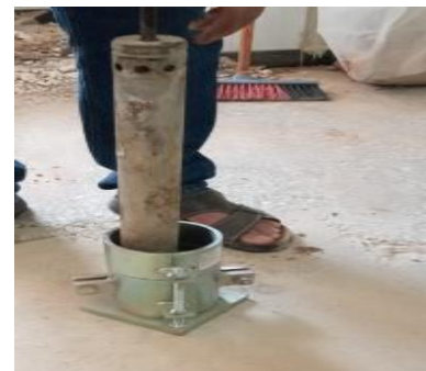
Photo III.12 : Étapes de réalisation de l'essai Proctor Normal sur le sédiment de Beni Bahdel.
