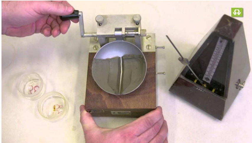
Photo III.8 : Appareil de Casagrande pour déterminer la limite de liquidité
