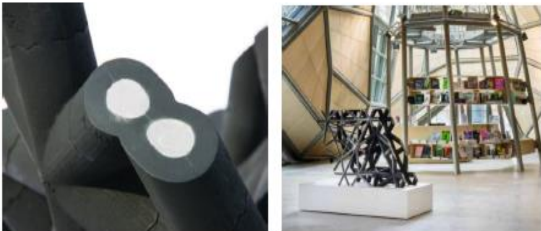
Figure 2.11 : Moule en sable réalisé par injection de liant par VoxelJet et pièce finale
