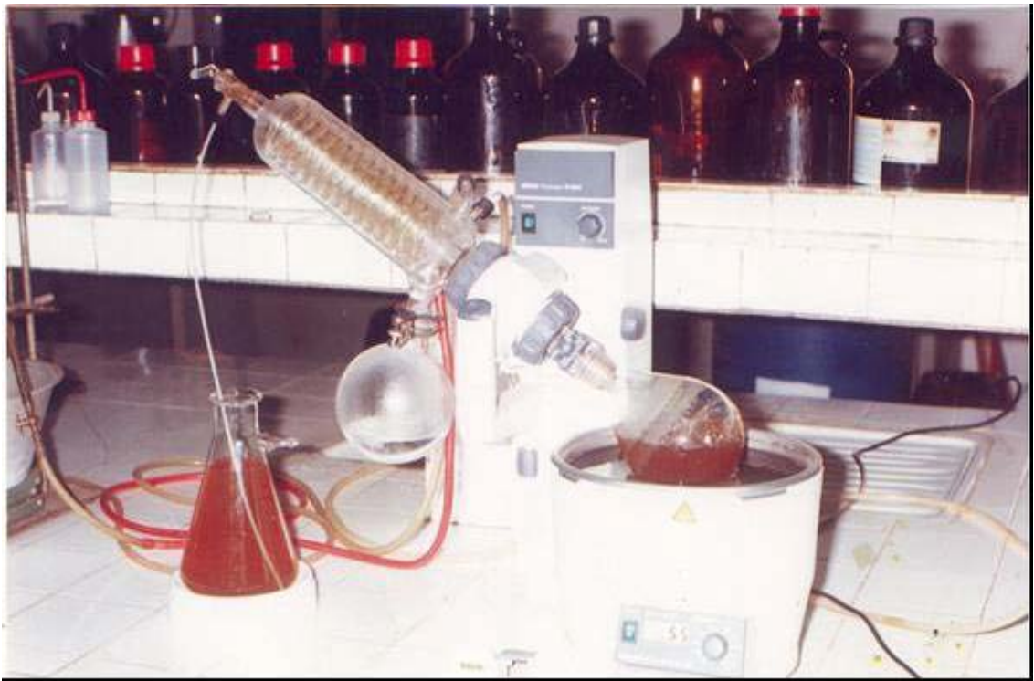
Figure n°10:Photo de rotavapor utilisé pour concentrer les extraits
