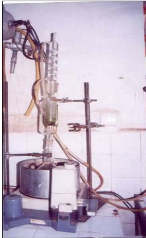
Figure n°9 : Photo de soxhlet pour les extractions par les solvants à polarité croissante
