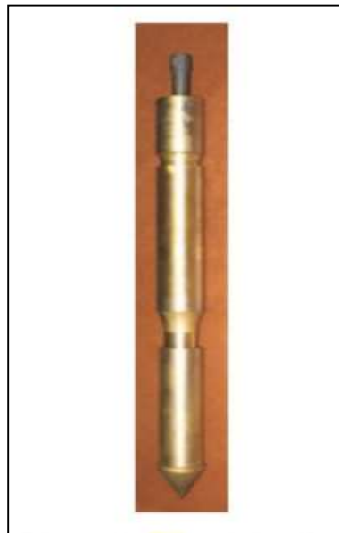
Figure 15: Exemple de point pénétrométrique
