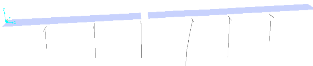
Figure 6-10 : : comportement du pont dans le mode 1 (longitudinale-pile4) suivant notre modélisation
