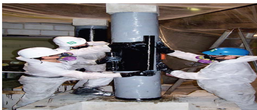
Figure I.13: Confinement d'un poteau par TFC uni axial. expérimentation [9]
