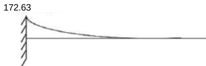
Figure 4.12 : Diagramme du moment fléchissant du support de chemin de roulement
