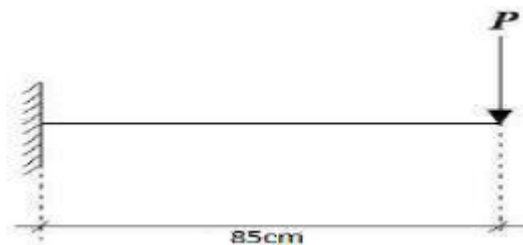
Figure 4.11 : Schéma statique du support de chemin de roulement
