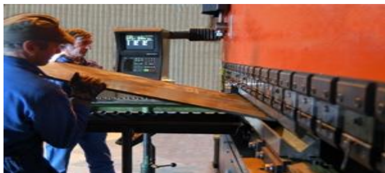
Figure 2.1 Pliage à la presse (Brilla, Rhône-Alpes)
