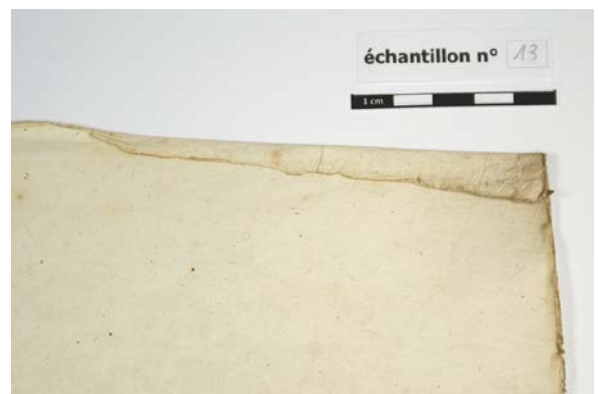
Figure 71 : certains bords peuvent présenter des plis, les coins peuvent être écornés et les bords abrasés.
