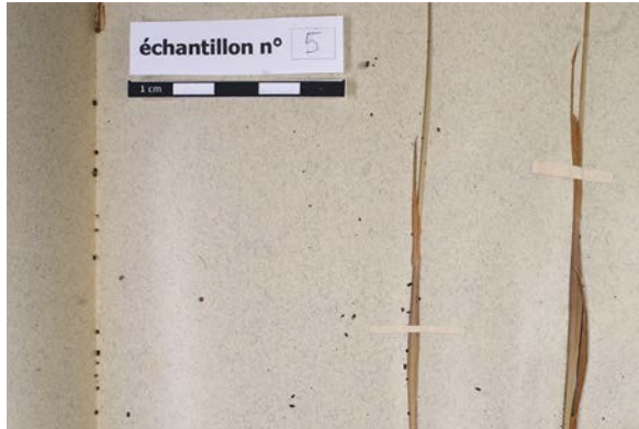
Figure 84 : perte de matière autour du spécimen.
