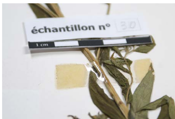
Figure 74 : l'adhésif de la fixation par ruban adhésif peut jaunir, voir même créer une auréole.
