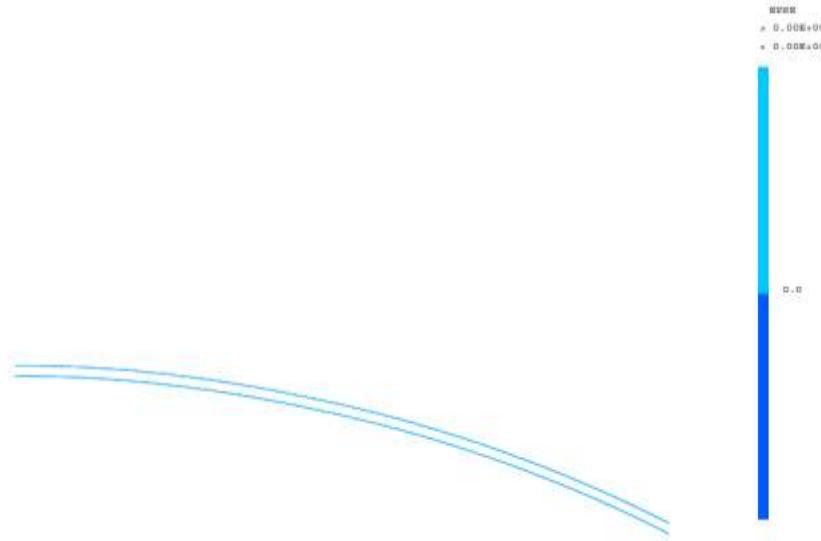
*Figure4.8 : Déformation sous l'effet d'impact de l'avion Cessna 210*
