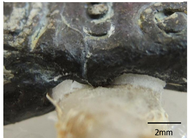
Photo 87 : Interface du lacs sortant (Face B) après traitement (reste de cyclododécane dans le lacs)
