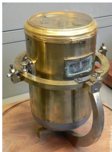
Photo 2 : Chronomètre de marine de Berthoud (1782). La partie inférieure grise servant de poids est en plomb
