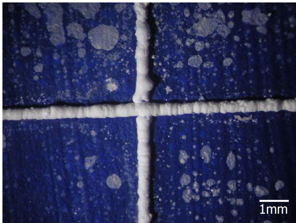
Photo 68 : Produits de corrosion formés au niveau de la lacune de la peinture sur du plomb avant traitement
