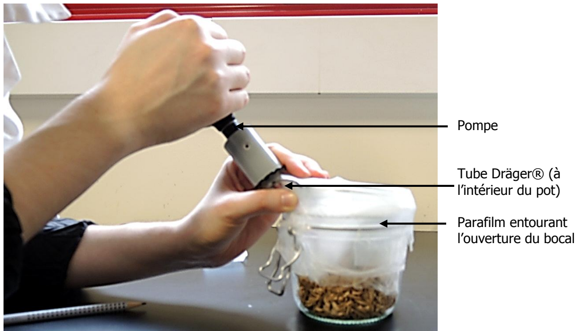
Photo 27 : Mesure de la concentration en acide acétique à l'intérieur des bocaux présentant des copeaux de chêne.
