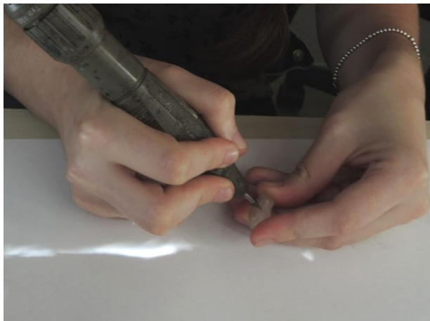
Photo 15 : Finition du bouton poussoir au microtour
