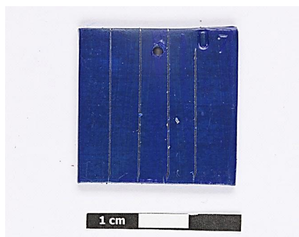
Photo 26 : Echantillon de type 3 : peinture à l'huile, rayures croisées
