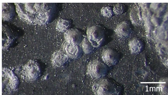
Photo 92 : Produits de corrosion sous forme de bubons
