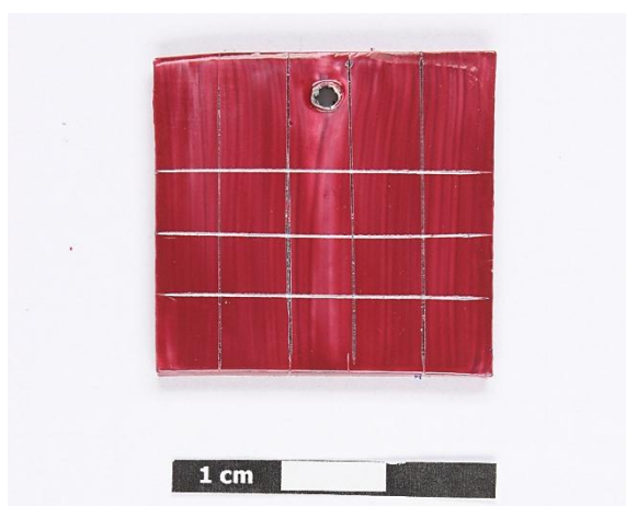
Photo 25 : Echantillon de type 3 : apprêt et peinture glycérophalique, rayures perpendiculaires
