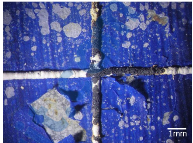
Photo 69 : Produits de corrosion réduits en partie au niveau de la lacune de la peinture sur du plomb et altération de celle-ci
