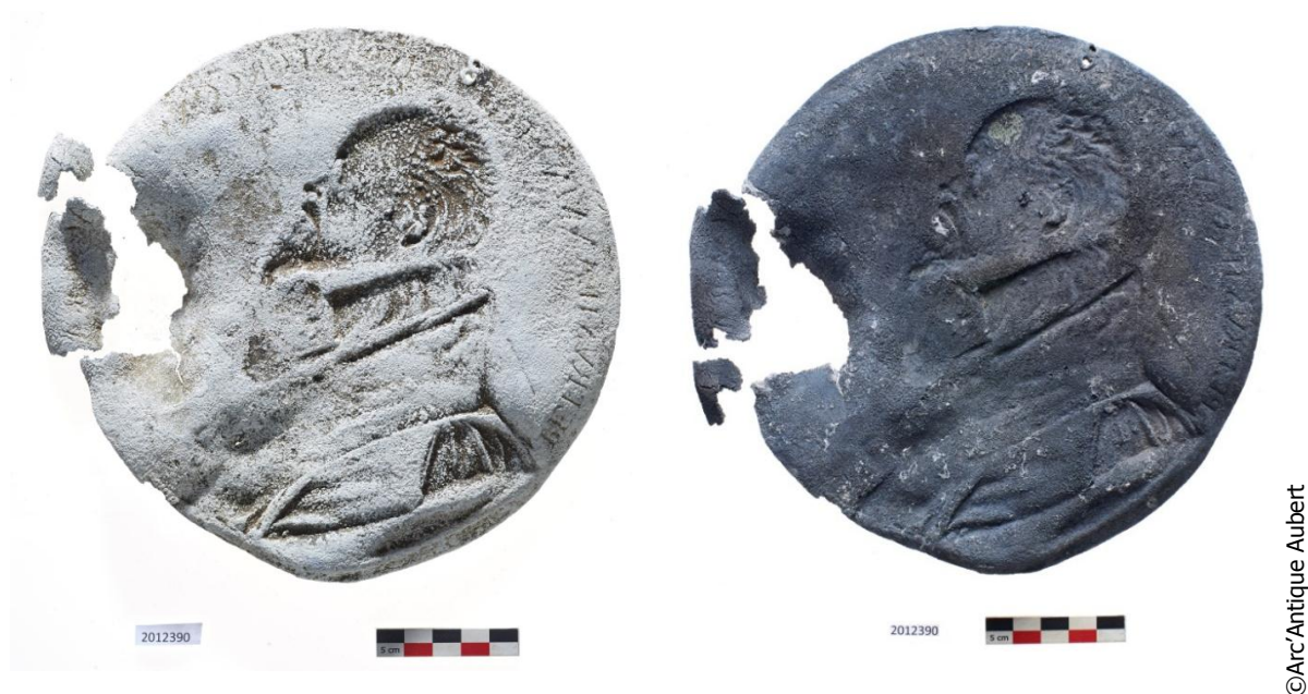
Photo 5 : Médaille de la Bibliothèque Nationale de France avant et après traitement de réduction en immersion dans le sulfate de sodium
