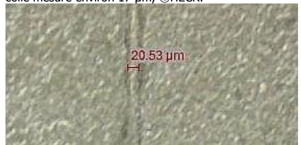
Ill. 74 : Vue sous binoculaire de l'épaisseur du joint de colle de l'éprouvette Verifix® LV740 / 2.7. Le joint de colle mesure environ 20 µm, ©HECR.
