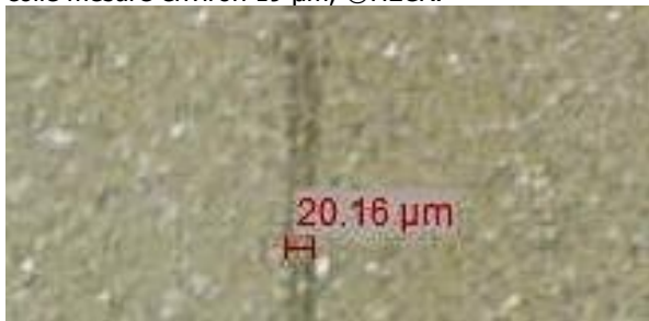
Ill. 71 : Vue sous binoculaire de l'épaisseur du joint de colle de l'éprouvette Conloc® 665 / 2.3. Le joint de colle mesure environ 18 µm, ©HECR.
