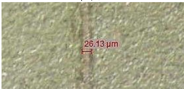
Ill. 73 : Vue sous binoculaire de l'épaisseur du joint de colle de l'éprouvette NOA® 61 / 2.3. Le joint de colle mesure environ 16 µm, ©HECR.
