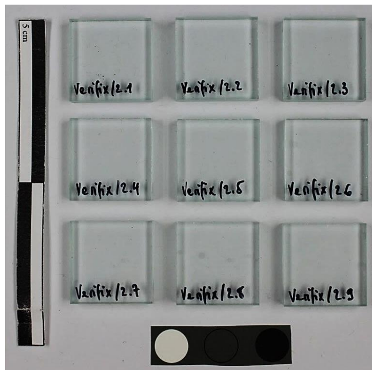
III. 63 : Eprovettes après découpe : Verifix® LV740, polymérisation durant 5 secondes à 45mW/cm 2 , ©HECR. Les éprovettes n° 7 à 9 comprennent quelques petites bulles d'air.
