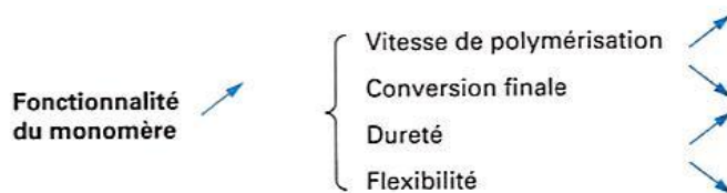
Ill. 8 : Cinétique de la polymérisation selon la fonctionnalité du monomère, ©Decker, 2007, AM 3 044, p.10
