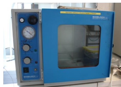
Ill. 18 : Les plaquettes sont déposées dans une chambre à vide durant 3 à 5 jours afin de dégazer le joint de colle, ©HECR
