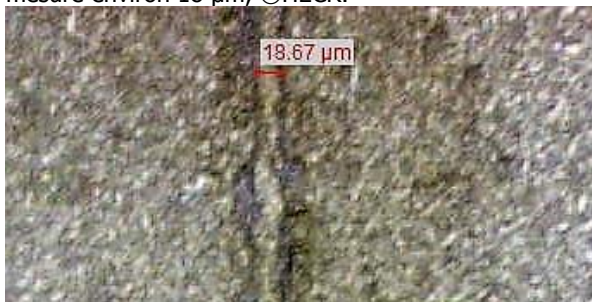
Ill. 70 : Vue sous binoculaire de l'épaisseur du joint de colle de l'éprouvette Verifix® LV740 / 1.7. Le joint de colle mesure environ 19 µm, ©HECR.
