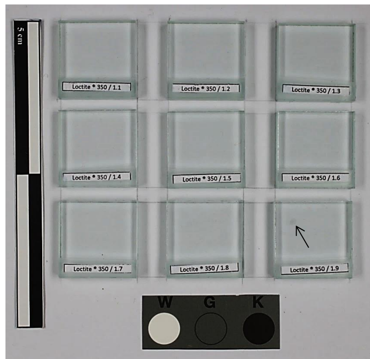
Ill. 57 : Eprovettes après découpe : Loctite® 350, polymérisation durant 10 minutes à 45mW/cm 2 , ©HECR. Toutes les éprovettes sont de très bonne qualité à l'exception de la n°9 qui comporte une bulle.
