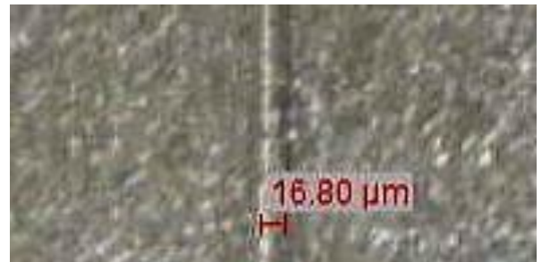
Ill. 72 : Vue sous binoculaire de l'épaisseur du joint de colle de l'éprouvette Loctite® 350 / 2.6. Le joint de colle mesure environ 17 µm, ©HECR.
