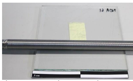
Ill. 16 : Répartition homogène de l'adhésif sur la plaquette à l'aide d'une barre de Mayer de calibre 50 µm, ©HECR
