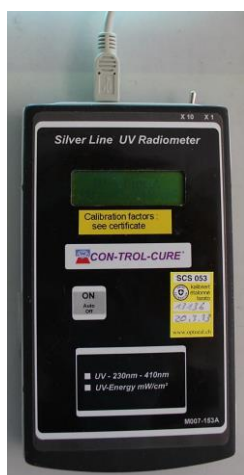
Ill. 20 : Radiomètre UV qui permet de mesurer l'intensité lumineuse réceptionné, ©HECR
