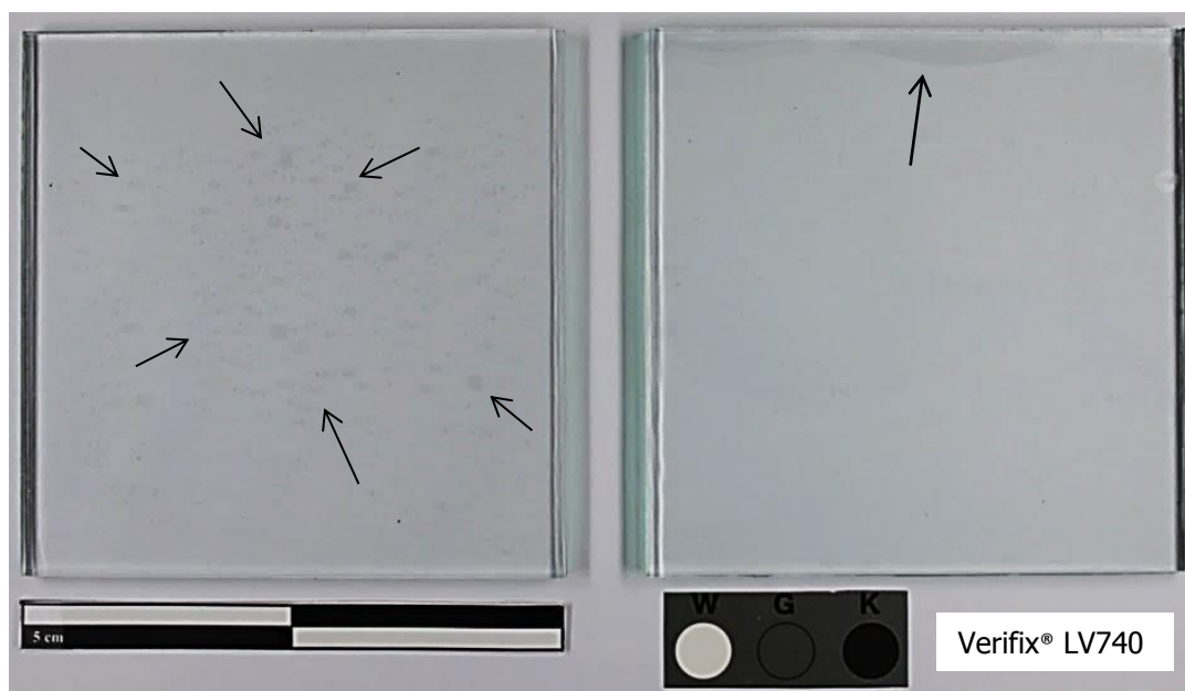
Ill. 14 : Verifix® LV740. A gauche : plaquette avant dégazage : on note la présence de nombreuses bulles d'air de petites dimensions. A droite : plaquette après dégazage : le joint de colle est complètement dégazé à l'exception d'un grande bulle d'air qui s'étend sur le côté supérieur de l'assemblage. Lors de la découpe, cette partie sera jetée. ©HECR
