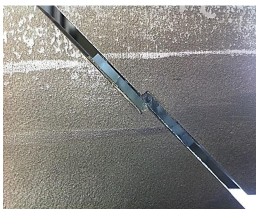
Ill. 39 : Dispositif après rupture ductile de l'éprouvette. On note que les deux plaquettes de verres ont été délaminiées sur environ 2 cm avant rupture, ©HECR
