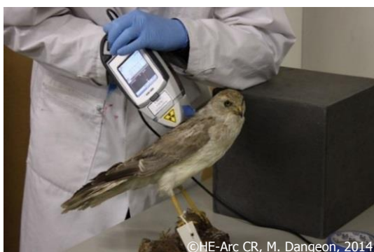
Fig. 12 : test de détection FRX sur un rapace
