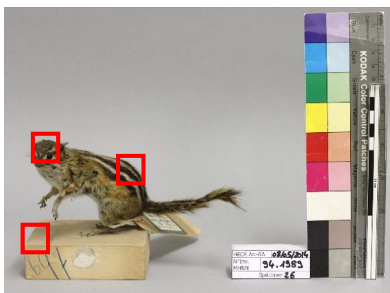
Figure 3 : emplacements des zones de tests pour la FRX sur les mammifères ©He-Arc CR, Marion Dangeon, 2014
