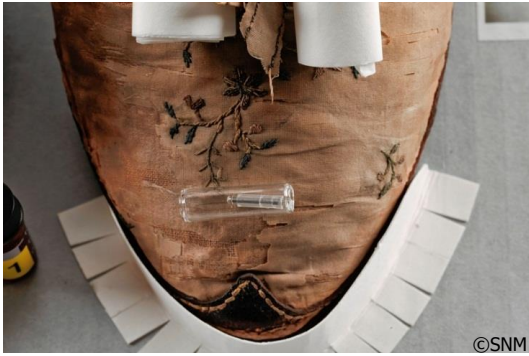
Fig. 21 : passive sampler sur une chaussure
