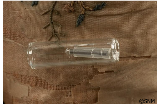
Fig. 22 : vue rapprochée du passive sampler
