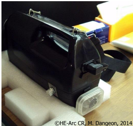
Fig. 34 : filtre medic air placé sur la sortie d'air d'un aspirateur de musée
