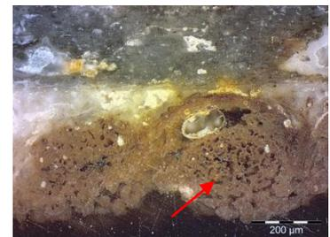
Figure 54 : Structure de fil, localisation de l'analyse FTIR, 1004-22, MO, DF, 100x ©HECR-Arc, 2013.
