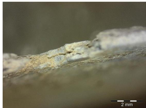
*Figure 31 : Fissure longitudinale située au niveau du trou, 1010-28 tranche, loupe binoculaire, 1.2x ©HECR-Arc, 2013.*
