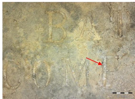
Figure 73 : Présence de produits de corrosion blancs dans les lettres, 1008-1 recto fragment A, loupe binoculaire, 0.67x ©HECR-Arc, 2013.
