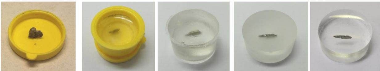
*Figure 126 : Etapes de préparation de l'échantillon : positionnement et collage, enrobage de résine, démoulage, polissage à la machine et à la main @HECR-Arc, 2013.*
