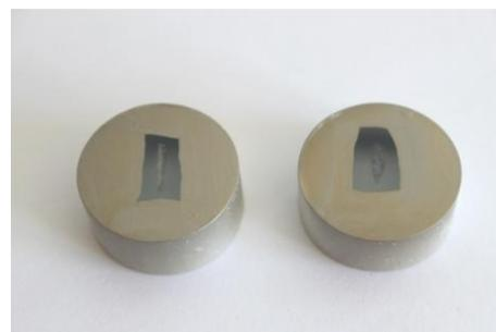
*Figure 127 : Echantillons préparés pour le microscope électronique à balayage @HECR-Arc, 2013.*
