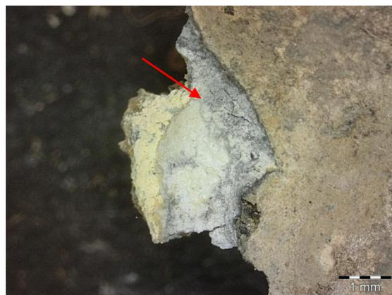
Figure 66 : Aspect de CP2i en coupe, 1004-22 verso fragment A, loupe binoculaire, 1.2x ©HECR-Arc, 2013.
