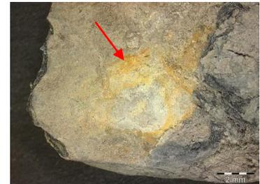
*Figure 59 : Dépôts d'oxydes de fer, 1004-22 recto fragment C, loupe binoculaire, 0.67x ©HECR-Arc, 2013.*
