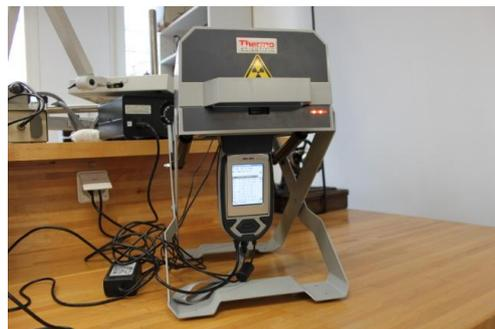
Figure 18 : Vue de l'installation XRF
