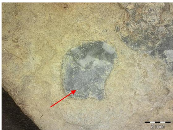
Figure 65 : Aspect de CP2i en surface (absence de sédiment), 1007-4 verso, loupe binoculaire, 0.67x ©HECR-Arc, 2013.
