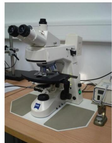
*Figure 15 : Microscope métallographique ©HECR-Arc, 2013.*
