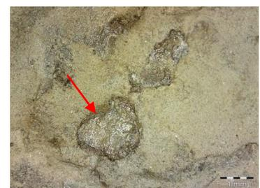
*Figure 60 : Couche dure et adhérente, parfois brillante 1007-4 recto, loupe binoculaire, 1.2x ©HECR-Arc, 2013.*
