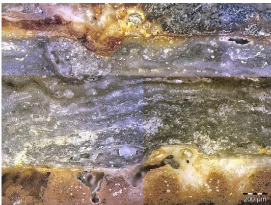
Figure 85 : Structure de la strate en coupe, 1004-22, MO, DF, 50x ©HECR-Arc, 2013.
