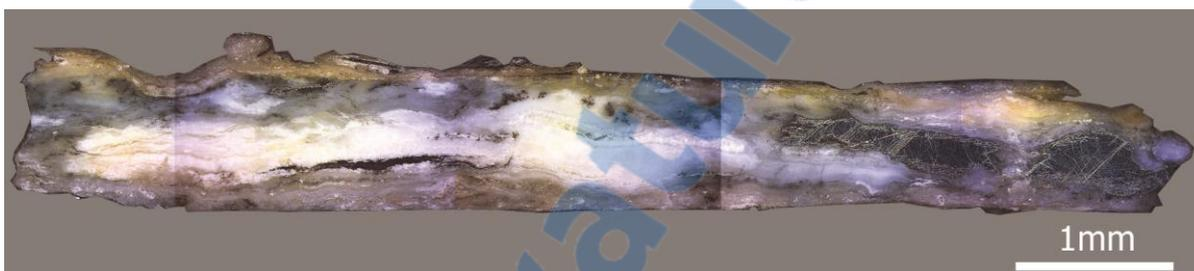
Figure 43 : Coupe transversale échantillon 1008-1, MO, DF, 50x ©HECR-Arc, 2013.
