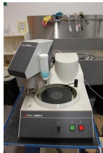
Figure 125 : Polisseuse LaboPol-5 ©HECR-Arc, 2013.
