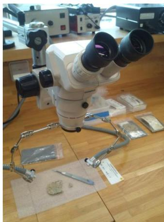
*Figure 14 : Loupe binoculaire utilisée en combinaison avec le scalpel ©HECR-Arc, 2013.*
