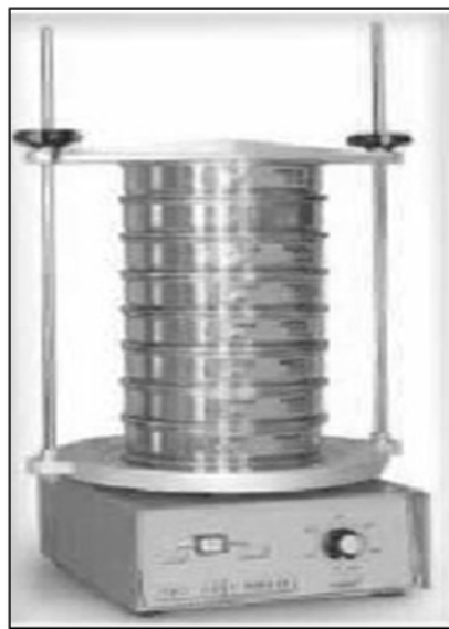
Figure III.1. Machine à tamiser électrique.
