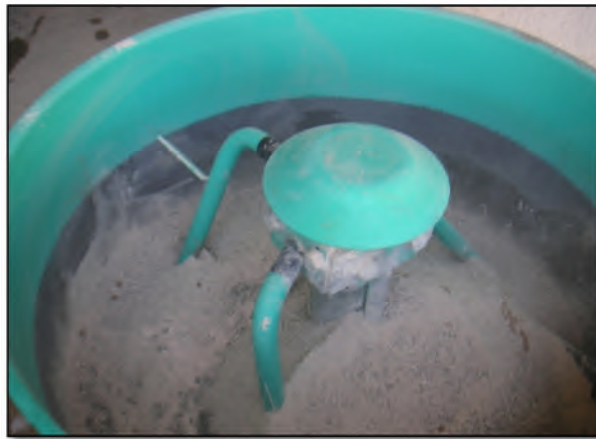
Figure IV.2. Malaxeur de béton.
