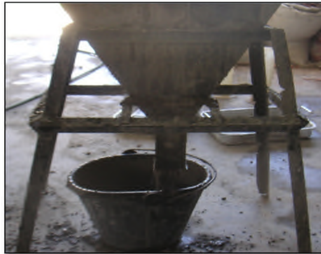
Figure IV.7. L'essai de V-Funnel.
