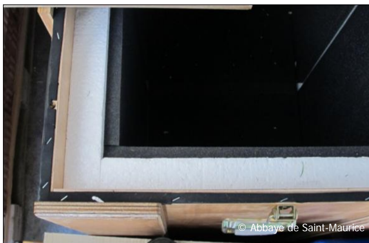
Figure 31 : Intérieur de la caisse interne, avec polystyrène et polyuréthane.
