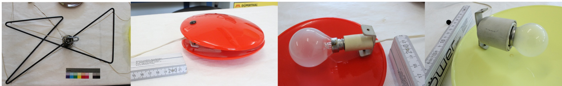
FIGURE 17, 18, 19 & 20 De gauche à droite : structure de la suspension (M1), suspension en PMMA (P1), petite douille en plastique (P2), grande douille en métal et porcelaine (M2). Sur ces deux dernières photographies sont aussi visible les axes de suspension (M3). ©HECR-Arc.
