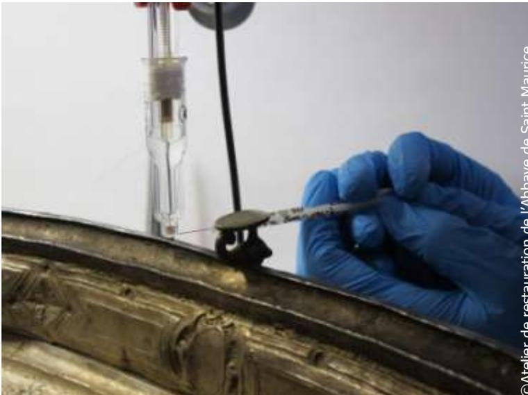
*Photo 9 : Insertion de la goutte de sesquicarbonate de sodium entre l'objet et le système électrode Ag-AgCl/rallonge*
