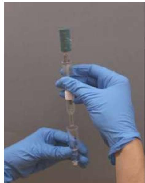
Photo 4 : Insertion de l'électrode dans la rallonge remplie de la solution test
