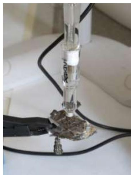
*Photo 19 : Mesure CLAMTEC au niveau de la surface ternie du caparaçon arrière de la statue équestre de Saint Maurice*
