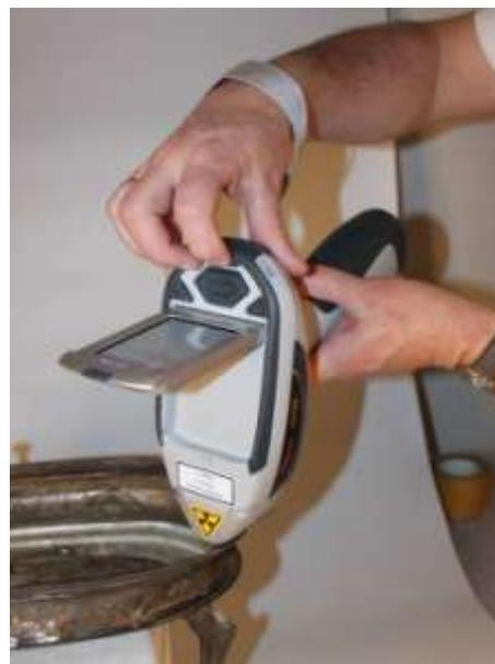
*Photo 9: Analyse par fluorescence X d'un objet du Trésor de l'Abbaye de Saint Maurice en dehors de l'enceinte close*
