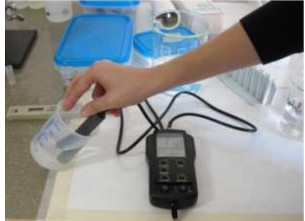
Photo 3 : Mesure de la conductivité de la solution  $KNO_3$
