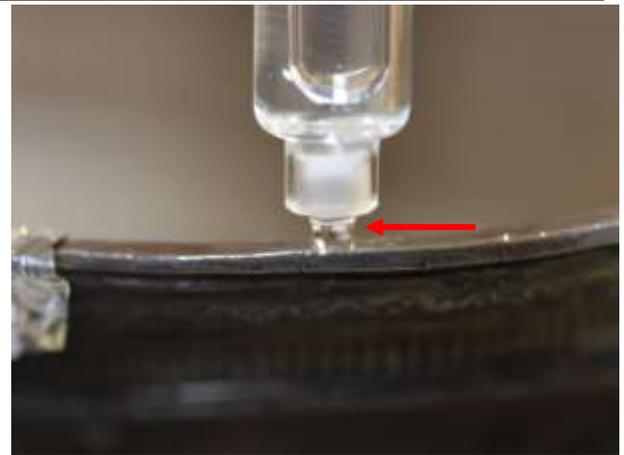
Photo 16 Vue de la goutte entre l'échantillon et le fritté de l'électrode
