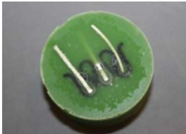
*Photo 8 : Echantillons enrobés après séchage de la résine*
