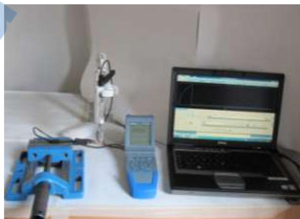
Photo 12 : Réalisation du blanc : Mesure en cours du potentiel de corrosion de l'échantillon de cuivre
