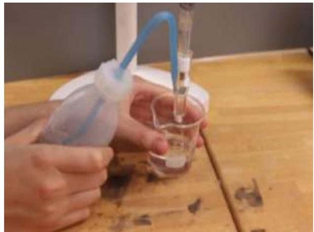
Photo 14 : Rinçage de l'électrode à l'eau déminéralisée
