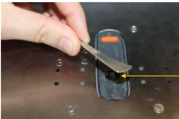
Photo 2 : Positionnement de l'échantillon dans la chambre d'analyse
