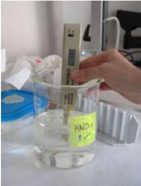
Photo 2 : Mesure du pH de la solution  $KNO_3$
