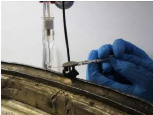
Photo 15 : Insertion de la goutte de solution entre le fritté de la rallonge et l'objet à l'aide d'une seringue
