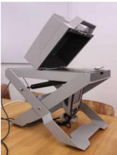
*Photo 8 : Positionnement d'un échantillon dans l'enceinte close de la FRX en vue d'une analyse de composition*
