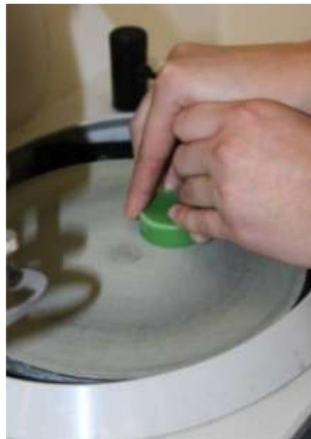
Photo 11 : Polissage des échantillons enrobés lors de l'étape 2
